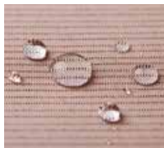
きもの地にシルラック-A加工を施すと、写真のように水や油をはじき、衣服への汚れの付着をしっかりガードします。
